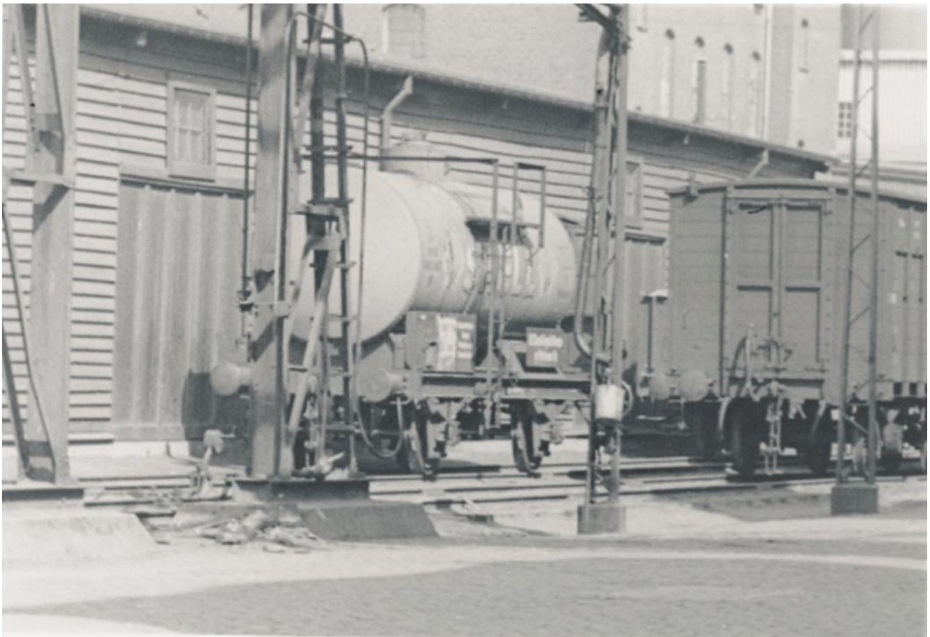
ZE 502 987. På Dansk Sojakage Fabrik. D. 12.04.1934. forunderligt nok har vognen (fået?) cylinderpuffere, man kunne have forventet - at med byggeår 1913, havde det været Kurvpuffer. Arkiv.: På Sporet.
